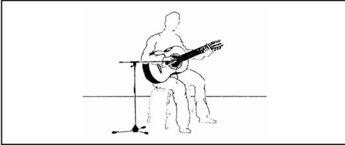
Fig. 11: Posizionamento del microfono per chitarra acustica
