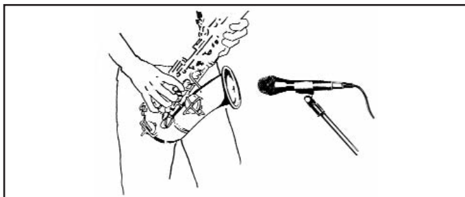
Fig. 10: Posicionamento do microfone para o saxofone
