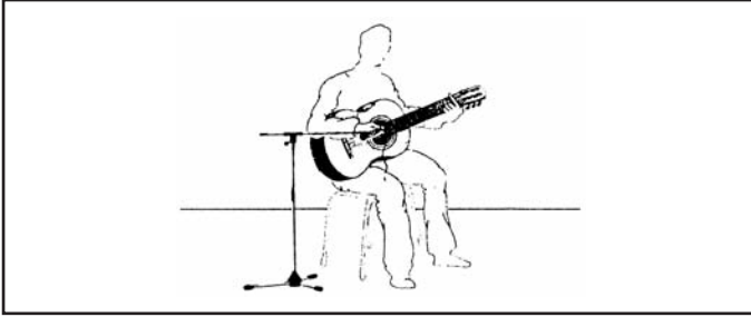
Fig. 11: Emplazamiento del micrófono para guitarra acústica
