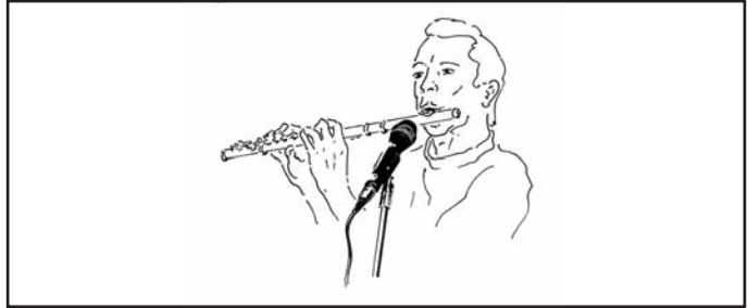
Fig. 9: emplazamiento del micrófono para flauta
